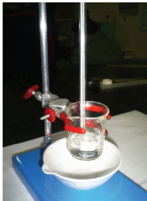
Figura 1 – Sistema para realização da queima de combustíveis
